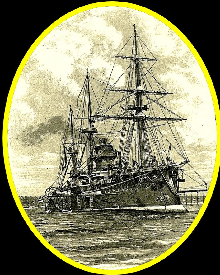
LE "REDOUTABLE", CUIRASSÉ DE 1ER RANG DE 9200 TONNEAUX, DE 97 MÈTRES DE LONG SUR 20 DE LARGE REÇUT 35 CENTIMÈTRES DE BLINDAGE À LA FLOTTAISON ET FUT LANCÉ EN 1876, IL RÉALISA UNE VITESSE DE 14 NOEUDS ET DEMI. ARMÉ DE 8 CANONS DE 27 ET 6 CANONS DE 14. LES CANONS-REVOLVERS ET À TIRS RAPIDES SONT AU NOMBRE DE 22. (C) COLLECTION HERVÉ BERNARD.
