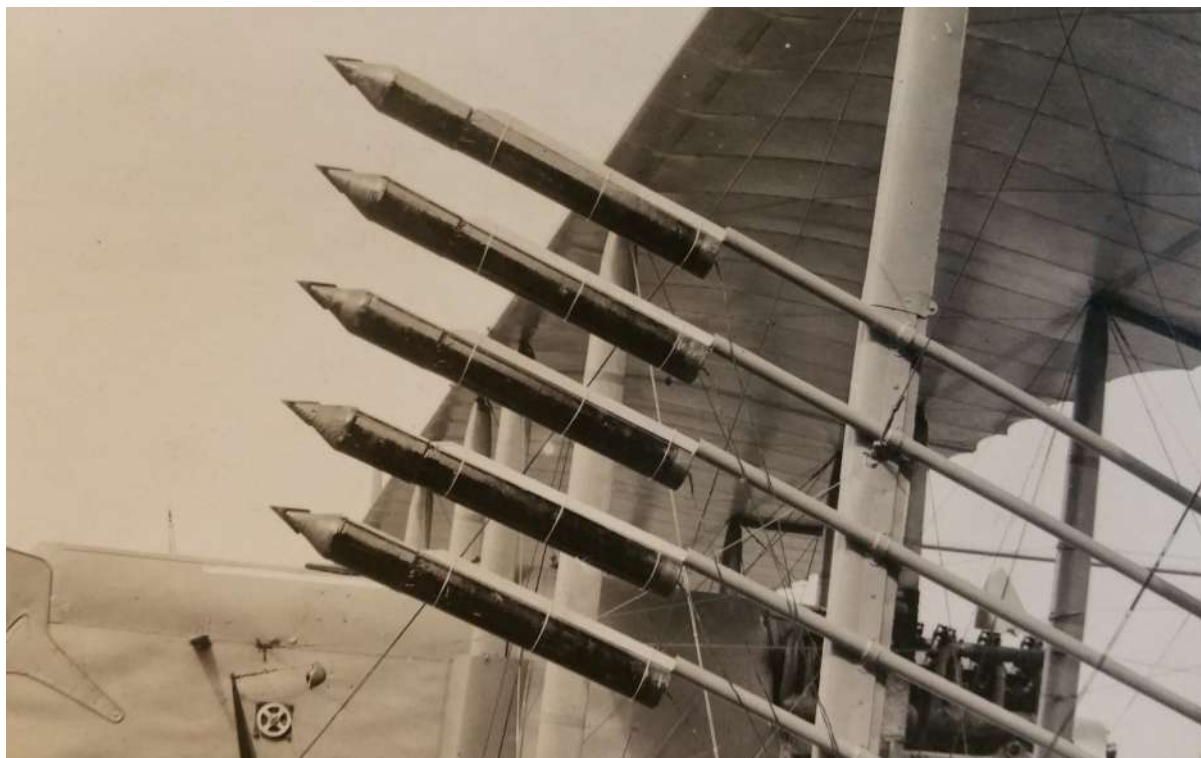
Détail du système de fusée inventé par le LV Leprieur © ECPAD
