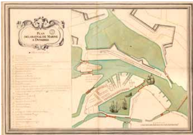
Plan de l'arsenal de marine à Dunkerque, 1671 (SHD Marine). Le premier parc de marine est édifié entre le chenal du havre et un bassin artificiel en cours de creusement. Magasins et ateliers sont distribués à proximité de trois cales de construction navale.
