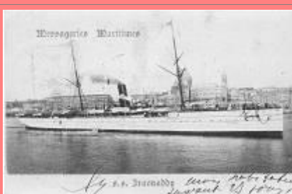
L'Iraouaddy dans le port de Marseille après les transformations: le troisième mat a disparu et la cheminée inclinée vers l'arrière est caractéristique
