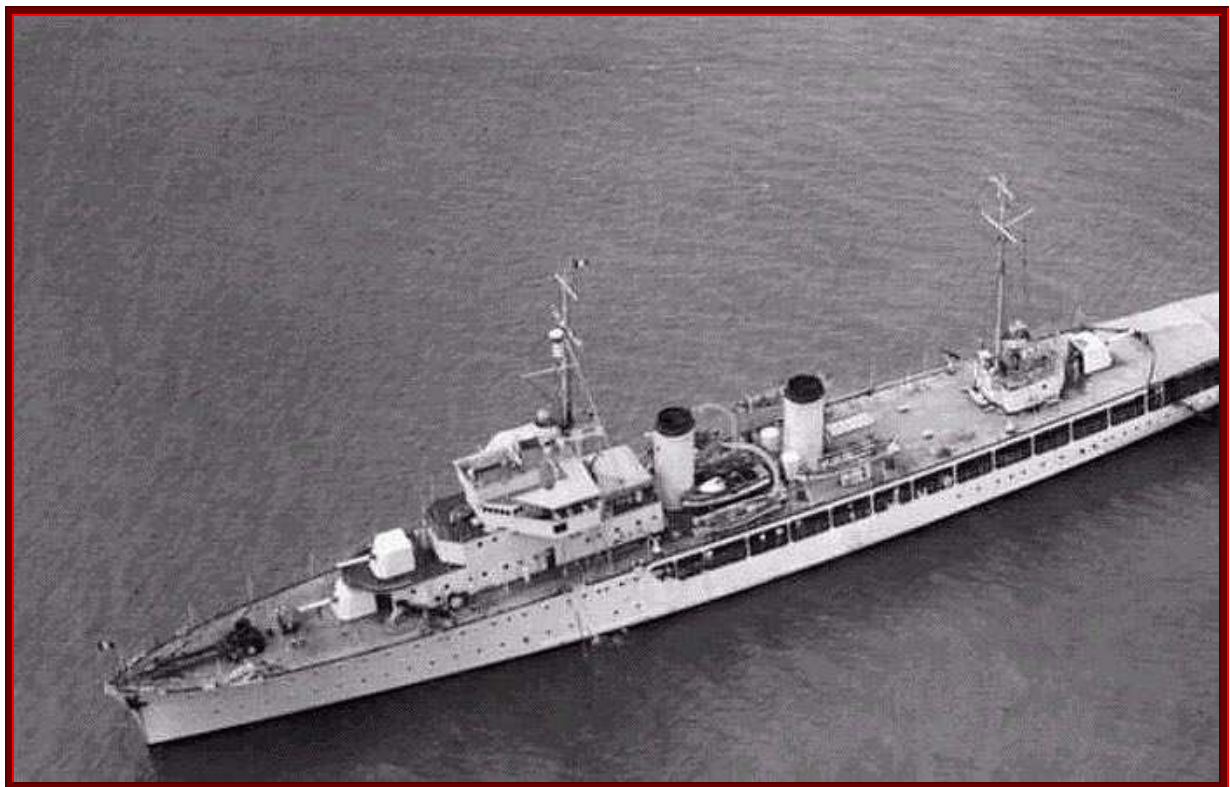
Vue aérienne du BOUGAINVILLE en 1933. 2600 tonnes, 104 mètres, 16 nœuds, 3 canons de 138 mm, 1 avion.
