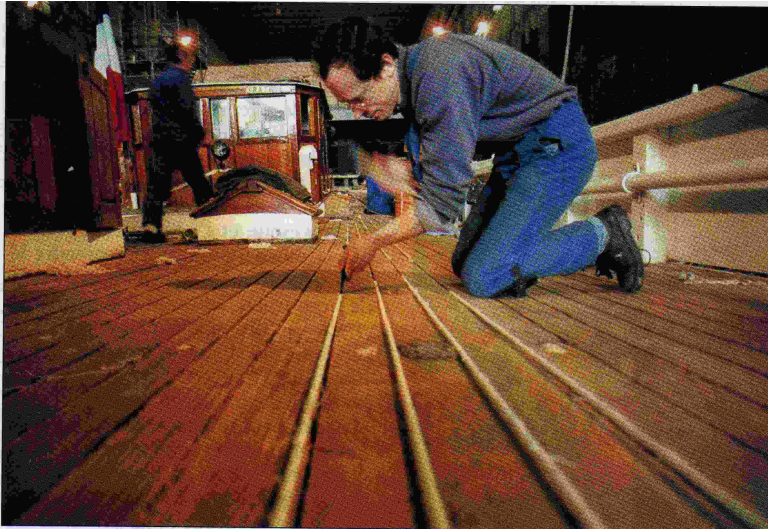
Bitord et coton sont insérés avec un fer à calfat. (Photo APP Brest / QM2 Kerivel)
