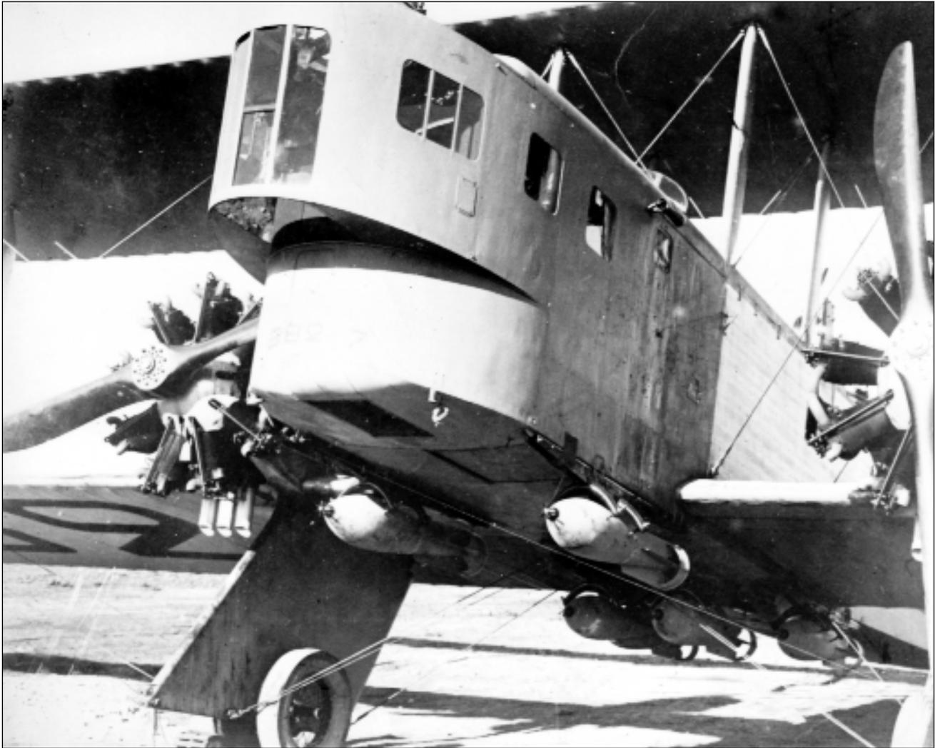
Ce gros plan du F.65 n° 216 (5B2.7) permet de voir de nombreux détails. Sous l'avant du fuselage, on distingue la trappe vitrée par laquelle se faisait la visée. L'appareil est armé de cinq bombes de 120 kg. (source Rumeau)
