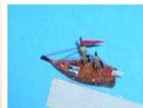
galiote à bombes en armement avec ses deux mats arrière le mat de misaine étant remplacé par les deux gros canons
